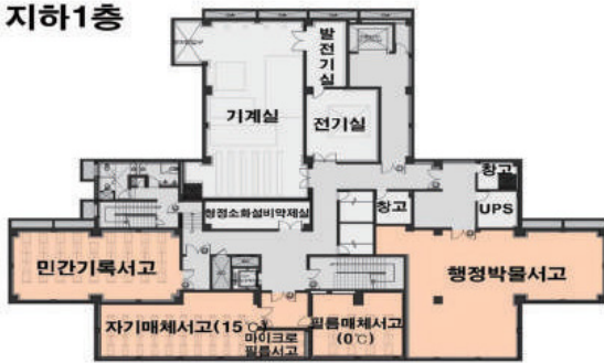
그림 16 경남기록원 지하 1층 평면도
